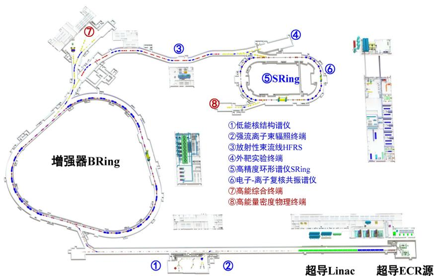
图 1.1: HIAF 装置的整体布局图。数字“⑦”标注了 HIAF 装置上高能物理终端的位置。
