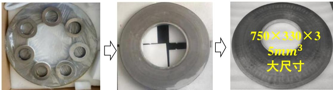
大尺寸纳米磁合金环在最具挑战的低频段(0.1-2MHz)性能超过国际公开报道的最好水平-国际领先
